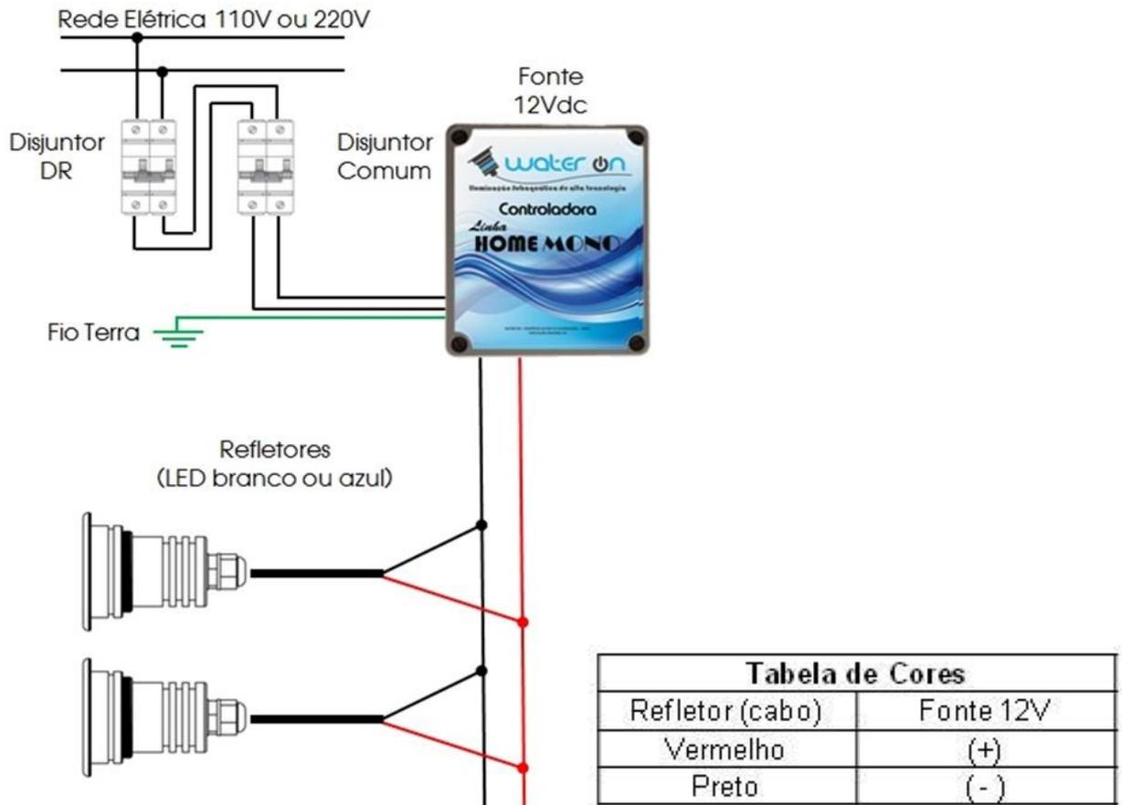
Os refletores Water On MONO (led branco ou azul) devem ser alimentados com uma fonte de tensão de 12V ou uma controladora mono, nunca ligar diretamente na rede elétrica.
