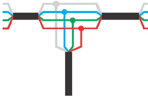
Nem todos os fabricantes fazem os refletores com as mesmas cores de cabos. Verifique com o fornecedor dos refletores quais são as cores correspondentes aos canais R (vermelho) G (verde) e B (azul) e ao canal + (comum 12V) e os ligue ao controlador como indicado acima.
