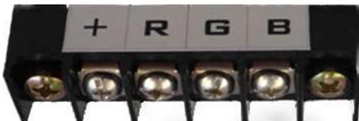
Na saída dos refletores é composto por um borne de 4 vias onde deve ser ligado os refletores RGB. No caso de caixas de potencia de alta corrente não tem o borne e sim cabos para se fazer as ligações.
