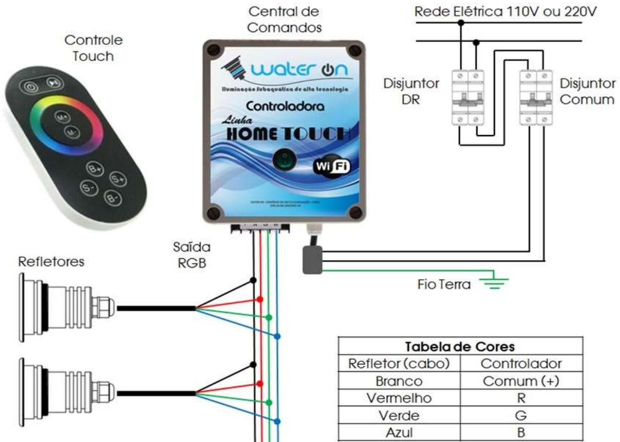
A caixa de comando tem a entrada de alimentação por um cabo PP de 3vias. O cabo que deve ser aterrado está identificado com uma etiqueta. Os outro dois cabos são ligados 110V (Fase / Neutro) e 220V (Fase / Fase). Dependendo da potência da caixa de comando é montado com fonte bivolt automático ou por seleção de voltagem por chave (ajustada por padrão em 220V). Isolar adequadamente a emenda para evitar choque elétrico.
