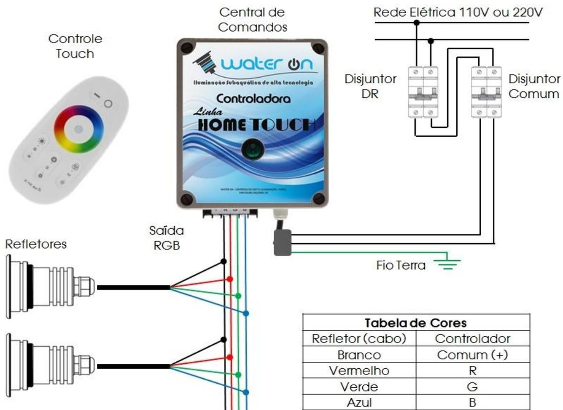
A caixa de comando tem a entrada de alimentação por um cabo PP de 3vias. O cabo que deve ser aterrado está identificado com uma etiqueta. Os outro dois cabos são ligados 110V (Fase / Neutro) e 220V (Fase / Fase). Dependendo da potência da caixa de comando é montado com fonte bivolt automático ou por seleção de voltagem por chave (ajustada por padrão em 220V). Isolar adequadamente a emenda para evitar choque elétrico.
