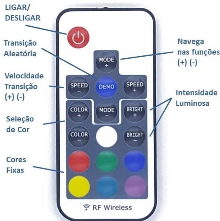
As funções podem controlar a intensidade luminosa e a velocidade de transição dos efeitos.
