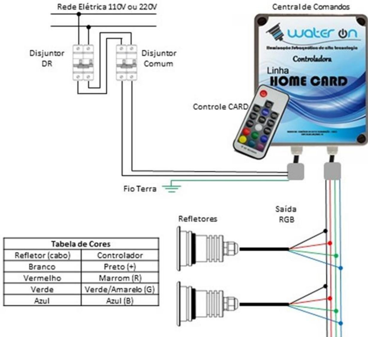
A caixa de comando tem a entrada de alimentação por um cabo PP de 3vias. O cabo que deve ser aterrado está identificado com a cor verde/amarelo (PP de 3 Vias). Os outro dois cabos são ligados 110V (Fase / Neutro) e 220V (Fase / Fase). Dependendo da potência da caixa de comando é montado com fonte bivolt automático ou por seleção de voltagem por chave (ajustada por padrão em 220V). Isolar adequadamente a emenda para evitar choque elétrico.
