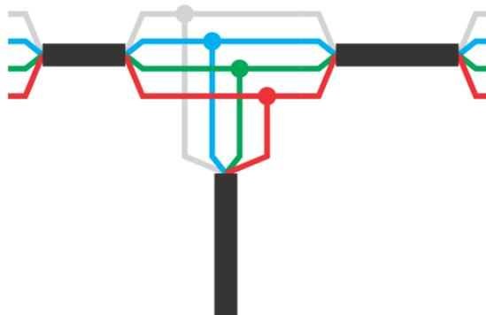
Nem todos os fabricantes fazem os refletores com as mesmas cores de cabos. Verifique com o fornecedor dos refletores quais são as cores correspondentes aos canais R (vermelho) G (verde) e B (azul) e ao canal C (comum 12V) e os ligue ao controlador como indicado acima.
